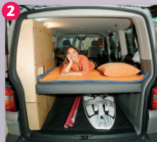
2 Hochstapler: Das Heckbett wurde gegenüber anderen Bullis auf VW-Basis um 22 Zentimeter nach oben gesetzt. Das schafft zusätzlichen Stauraum für Sportgeräte oder Gepäckstücke.
